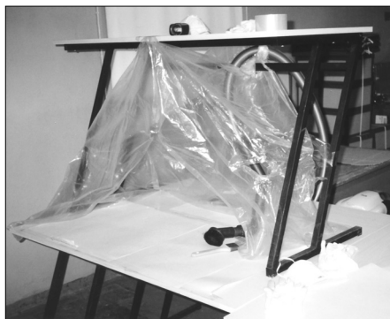
Foto 12. Käepärastest vahenditest ehitatud tõmbekapp hallituskahjustustega ja tolmu- nud esemete puhastamiseks.
