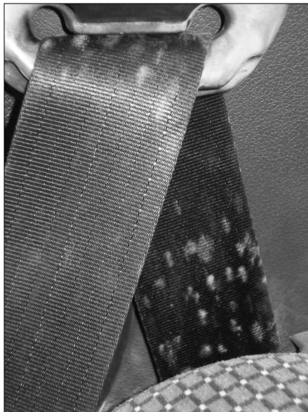
Foto 6. Hallitusseened on võimelised kahjustama ka sünteetilisi materjale, mida harilikult peetakse biokahjustuskindlaks.
