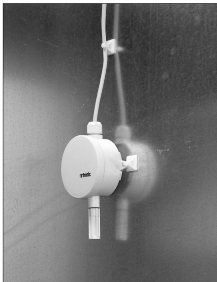
Foto 9. Hoidlas asuv statsionaarne andur, mis mõõdab temperatuuri ja suhtelist õhuniiskust.
