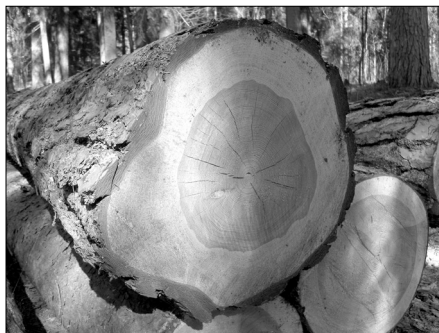
Foto 31. Männipuidus on selgelt eristatav heledam maltspuit ja tumedam lülipuit.
