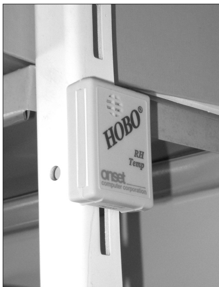
Foto 8. Ruumiõhu temperatuuri ja suhtelist õhuniiskust mõõtev logger.
